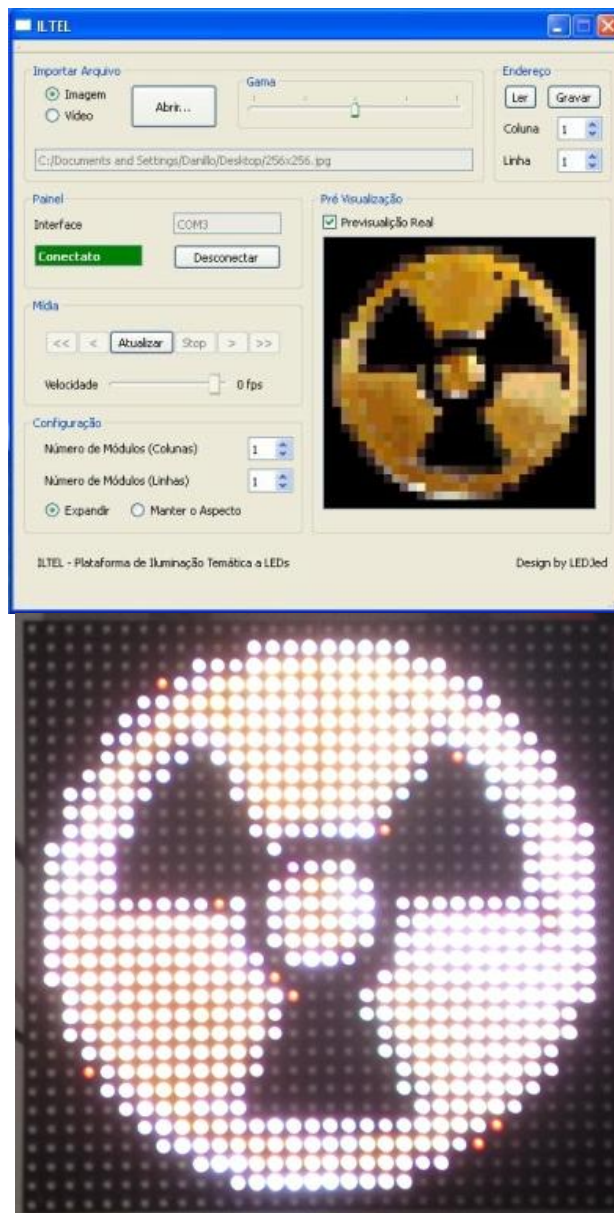
Figura 41 - Pré-Visualização Real e um módulo 32x32 na posição 1x1. Fonte: Autoria própria.
