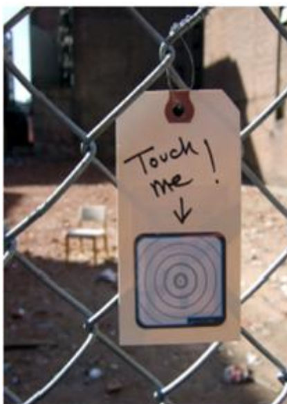
Figura 2 – Etiqueta RFID passiva.
