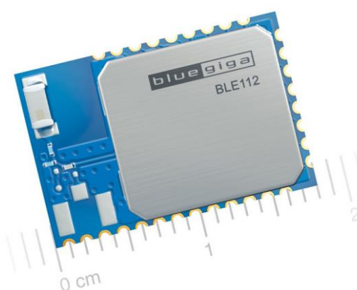
Figura 12 – Módulo de rádio Bluetooth 4.0, da Bluegiga. FONTE: Bluegiga Technologies
