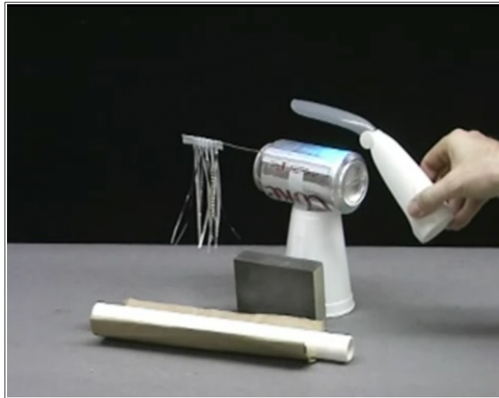
Figura 9: Experimento simples do Efeito Fotoelétrico.
