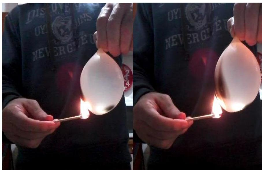
Figura 2 - Experimento do calor específico da água
