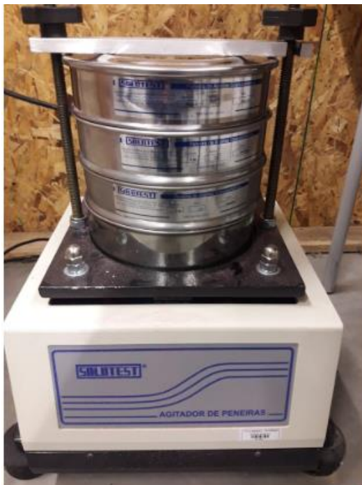
Figura 20. Fotografia do agitador de peneiras e as peneiras utilizado para o peneiramento das microcápsulas
