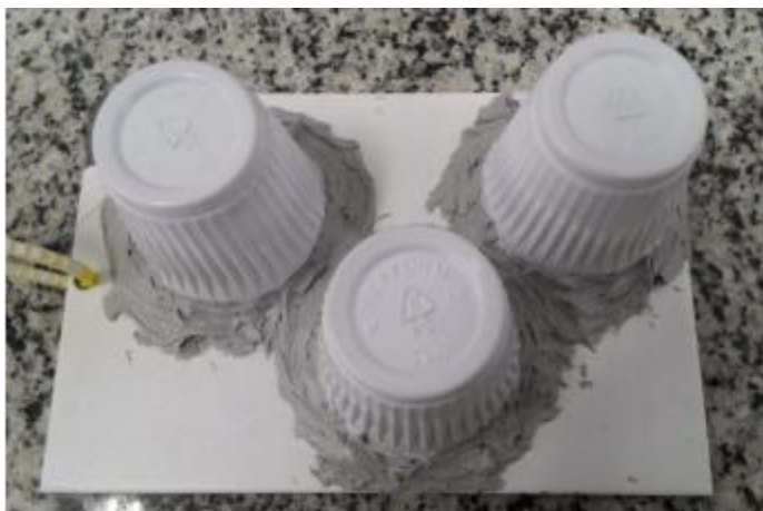
Figura 27. Fotografia da célula eletroquímica após a aplicação do adesivo de poliuretano
