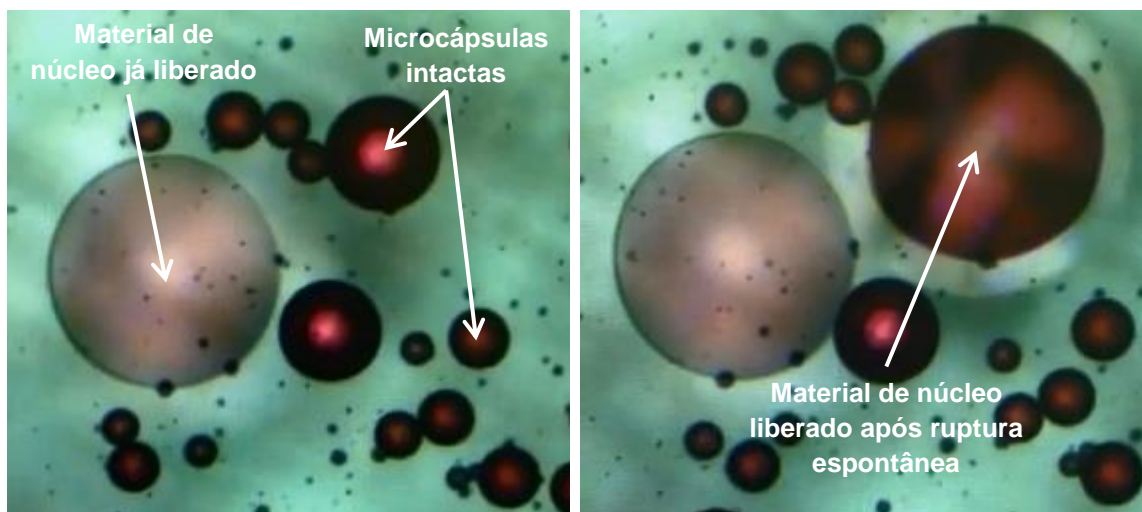
Figura 9 - Imagens de Microscopia Ótica do momento de ruptura espontânea das microcápsulas
