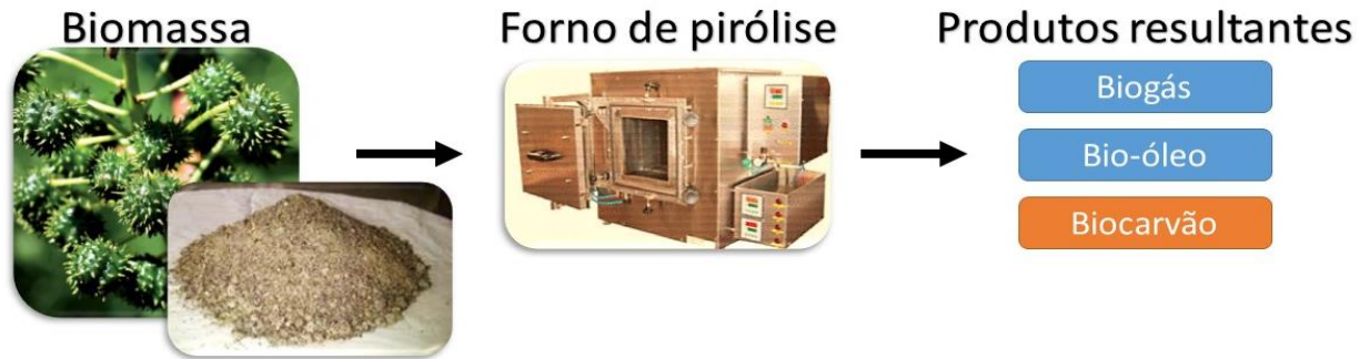
Figura 2 - Esquema representativo da produção de biocarvão, bio-óleo e biogás em laboratório a partir do farelo de mamona. 6
