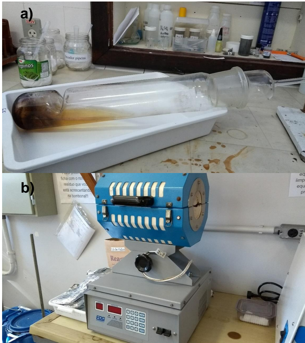
Figura 9a) – Reator de vidro utilizado no interior do forno de pirólise, onde foi adicionada a biomassa selecionada. b) Forno EDG FT-40 utilizado para o processo de pirólise do farelo de mamona
