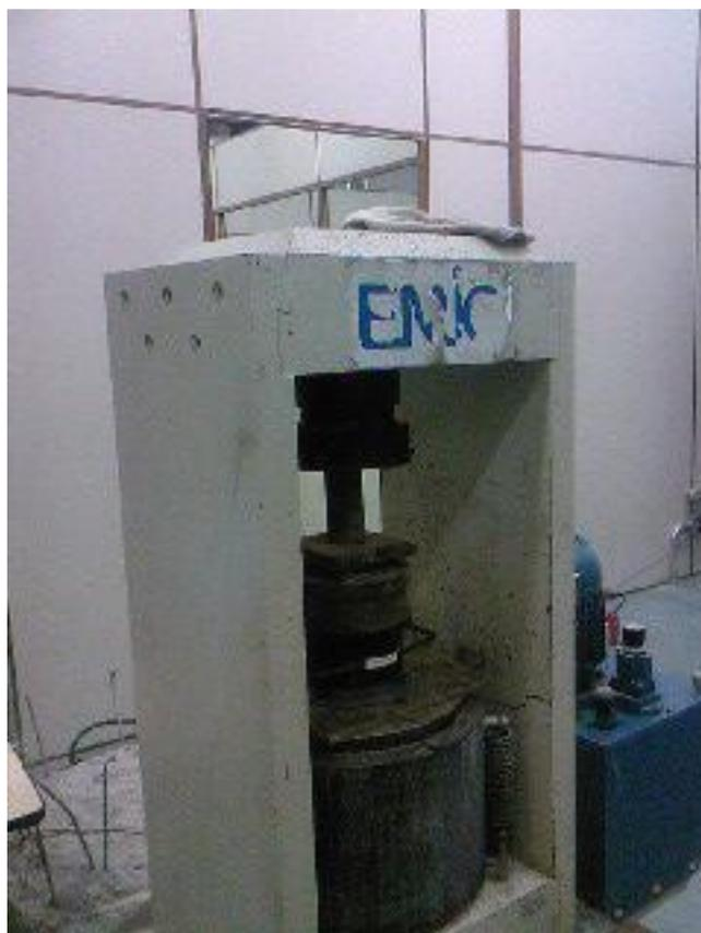
Figura 12 - Rompimento a compressão do corpo de prova
