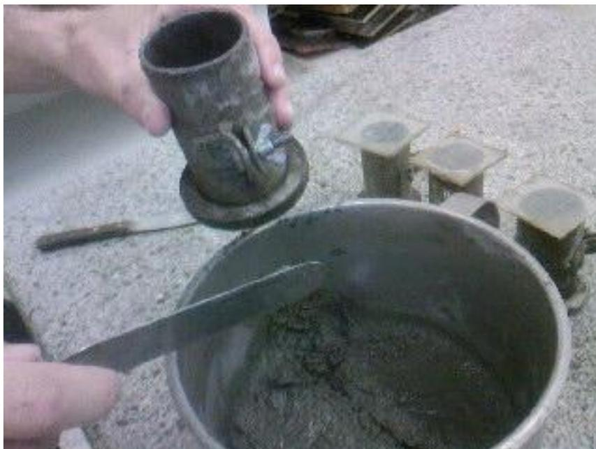
**Figura 8 - Preparação dos corpos de prova**
