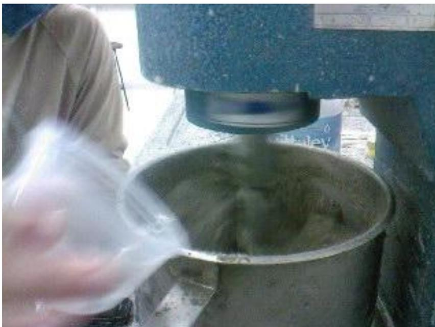
**Figura 4 - Preparação do concreto na argamassadeira**
