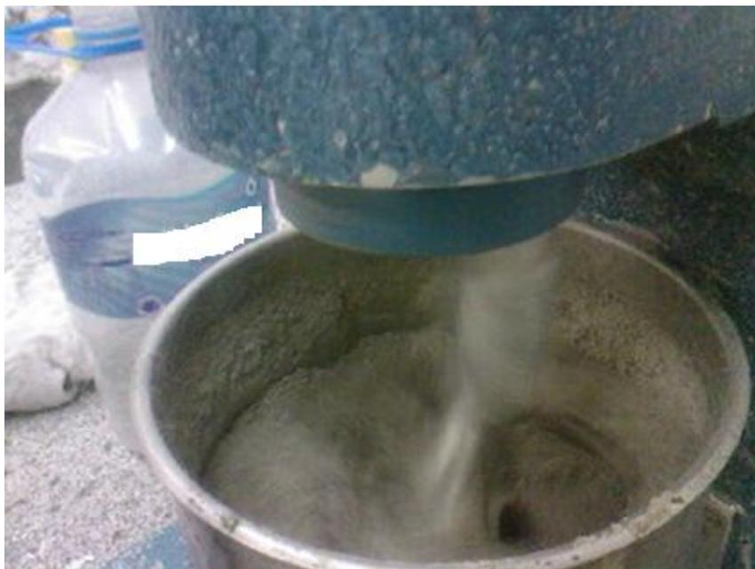
**Figura 5 - Preparação do concreto na argamassadeira**
