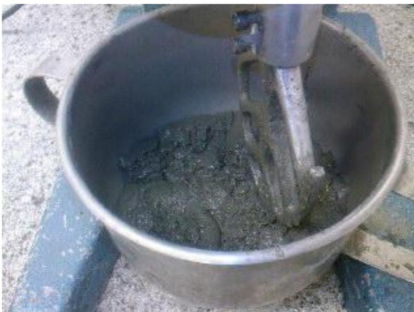
**Figura 6 - Aspecto do concreto na argamassadeira**
