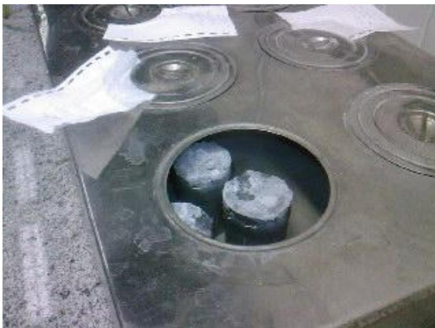
Figura 10 - Cura térmica a 90°C
