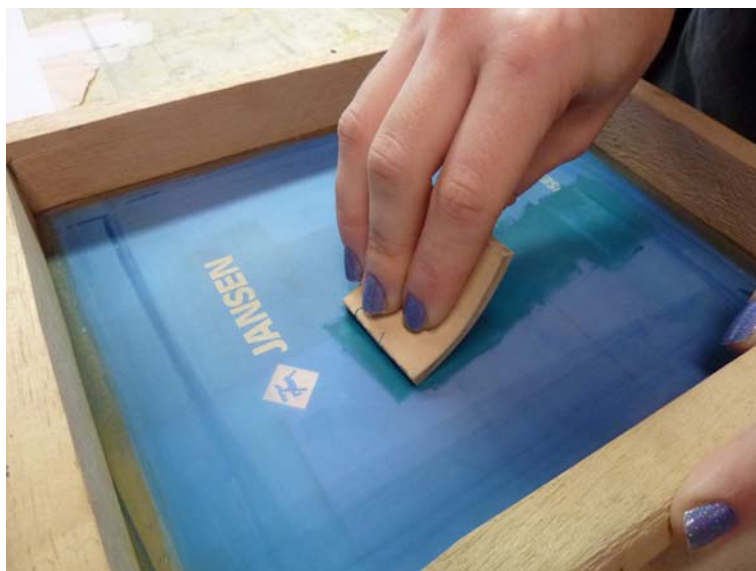
Figura 41 – Aplicação de serigrafia sobre o papel reciclado artesanal Fonte: A autora (2011).
