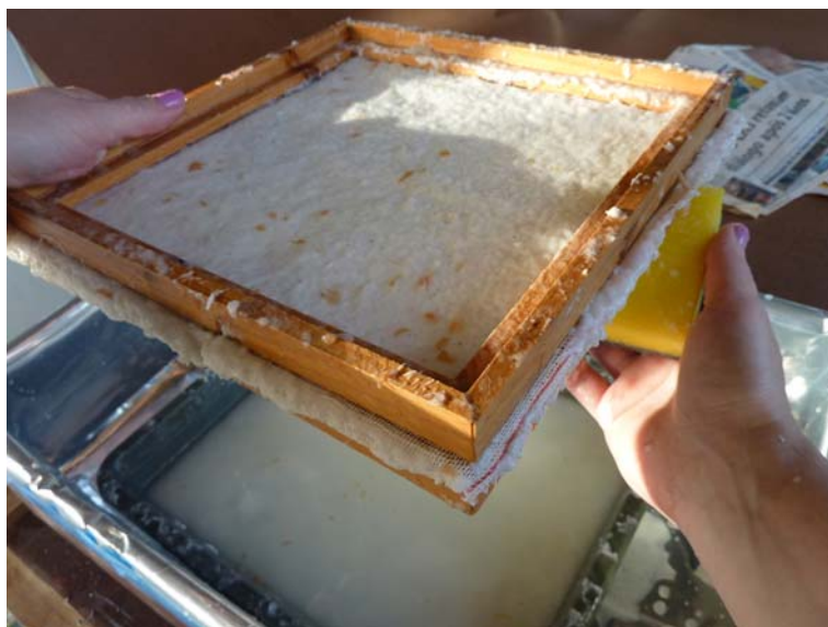
Figura 23 – Retirada do excesso de água com uma esponja Fonte: A autora (2011).
