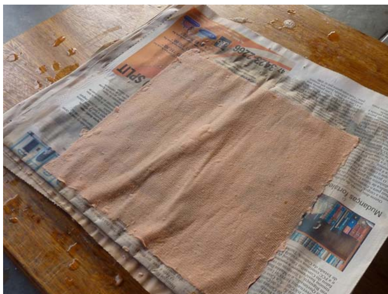
Figura 26 – Folha de papel reciclado depositada sobre o jornal Fonte: A autora (2011).
