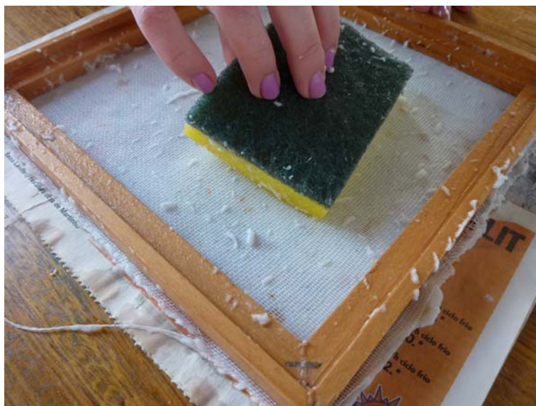
Figura 25 – Esponja pressionada para retirar o excesso de água Fonte: A autora (2011).
