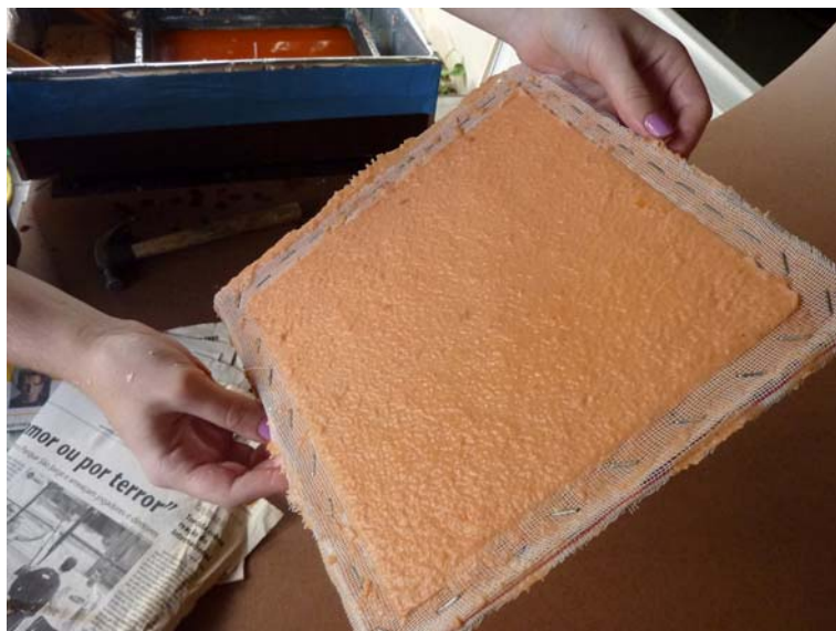
Figura 24 – Retirada da moldura de madeira Fonte: A autora (2011).
