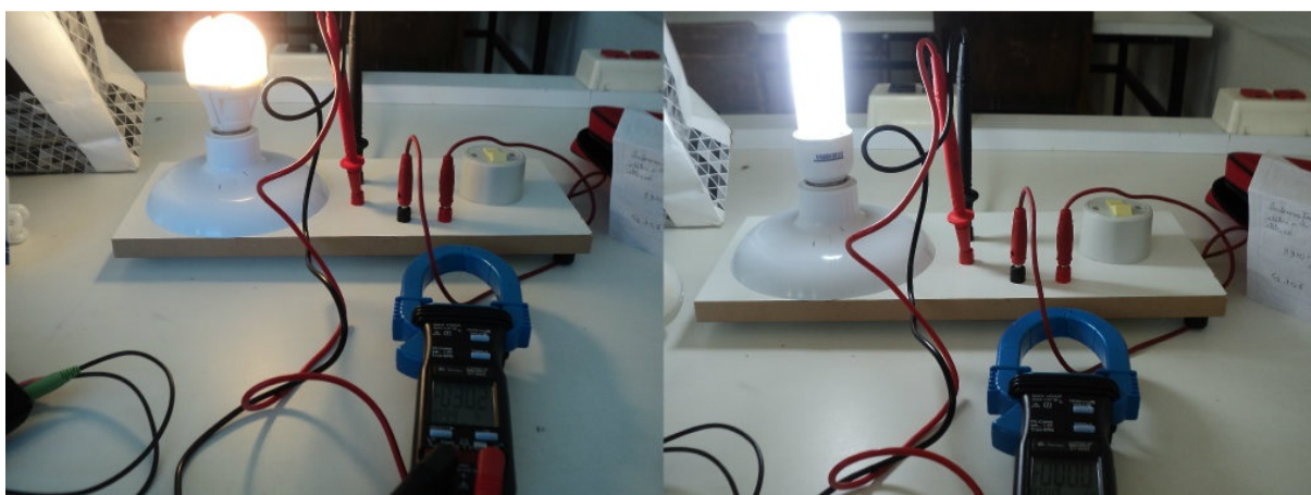
Figura 30 - Medições com o Wattímetro Alicate Fonte: Autoria própria.
