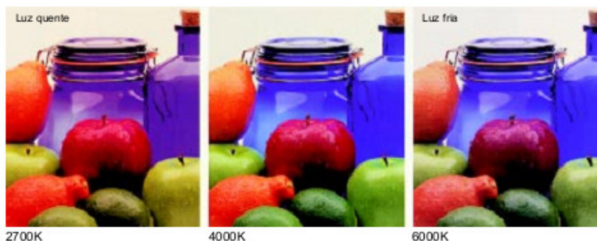
Figura 9 - Temperatura de Cor Fonte: OSRAM (2007).
