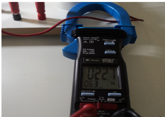
Figura 28 - Wattímetro Alicate Minipa ET-4090 Fonte: Autoria própria.
