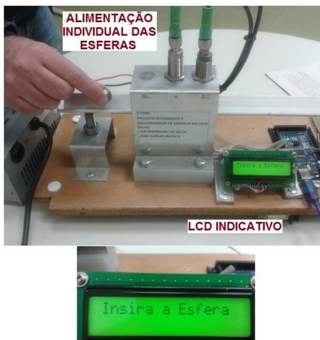
FIGURA 27 - PASSO 7: ALIMENTAÇÃO DAS ESFERAS
