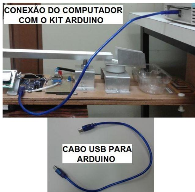
FIGURA 24 - PASSO 4: CONEXÃO COMPUTADOR/ARDUINO
