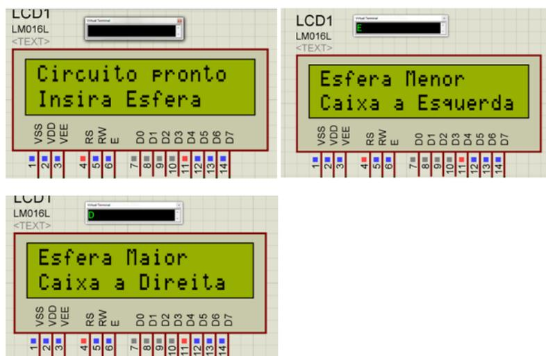
FIGURA 19 - TELA AMPLIADA DO LCD DO PROTEUS
