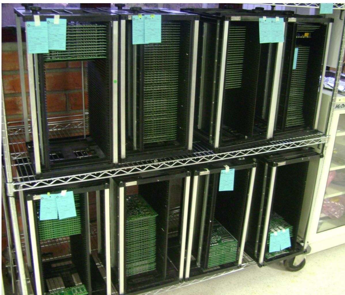
**Figura 03 - Buffer de painéis montados aguardando a inspeção óptica**
