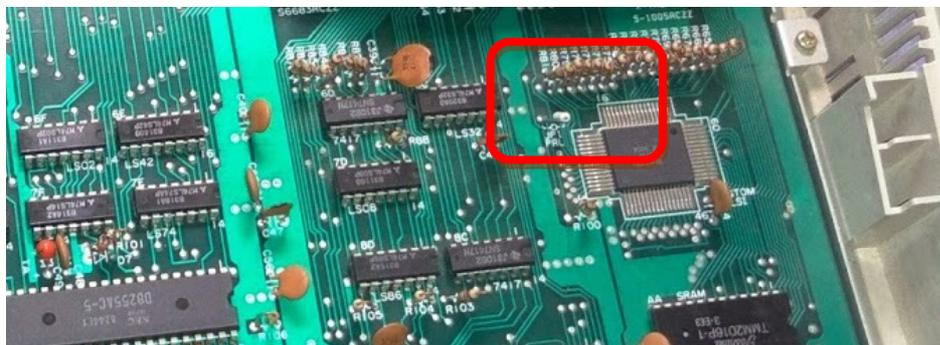
**Figura 16 – Microcomputador Sharp MZ-700 com tecnologia SMT (1982)
