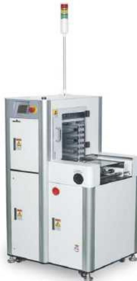
**Figura 24 - *Buffer*, antecessor a máquina de inspeção automática**
