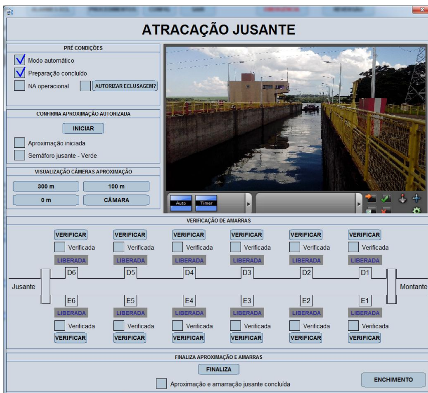
Figura 20 - Tela de Atracção Jusante para Montante Fonte: Autoria Própria
