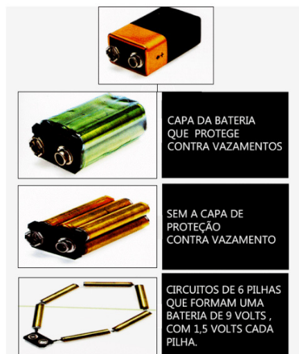
Figura 12 - Detalhe da forma construtiva da bateria de 9 VCC
