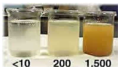
Figura 6 – Exemplos de níveis de turbidez da água em UNT's. Fonte: UNIVERSIDADE... (2015a)
