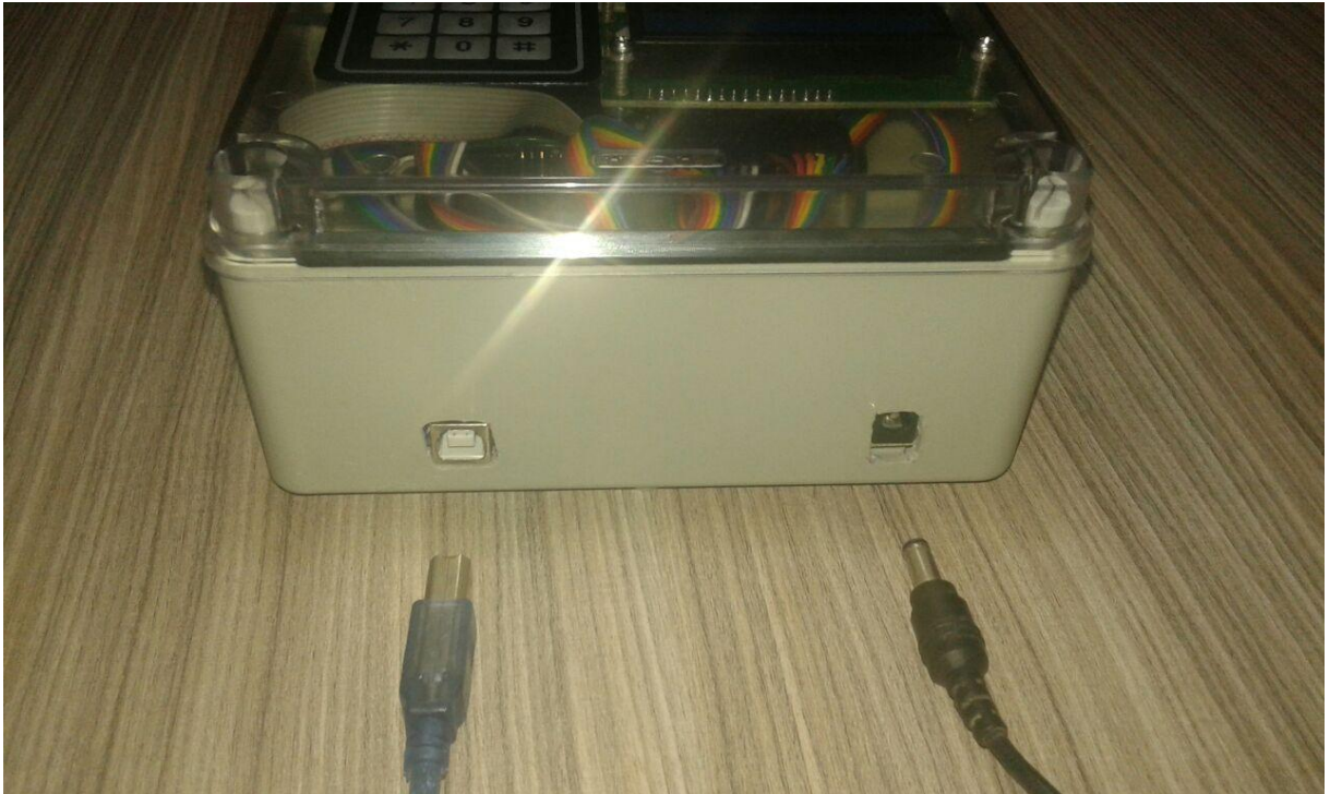
Figura 9 – Porta USB tipo B standard e entrada Jack Fonte: Autoria própria
