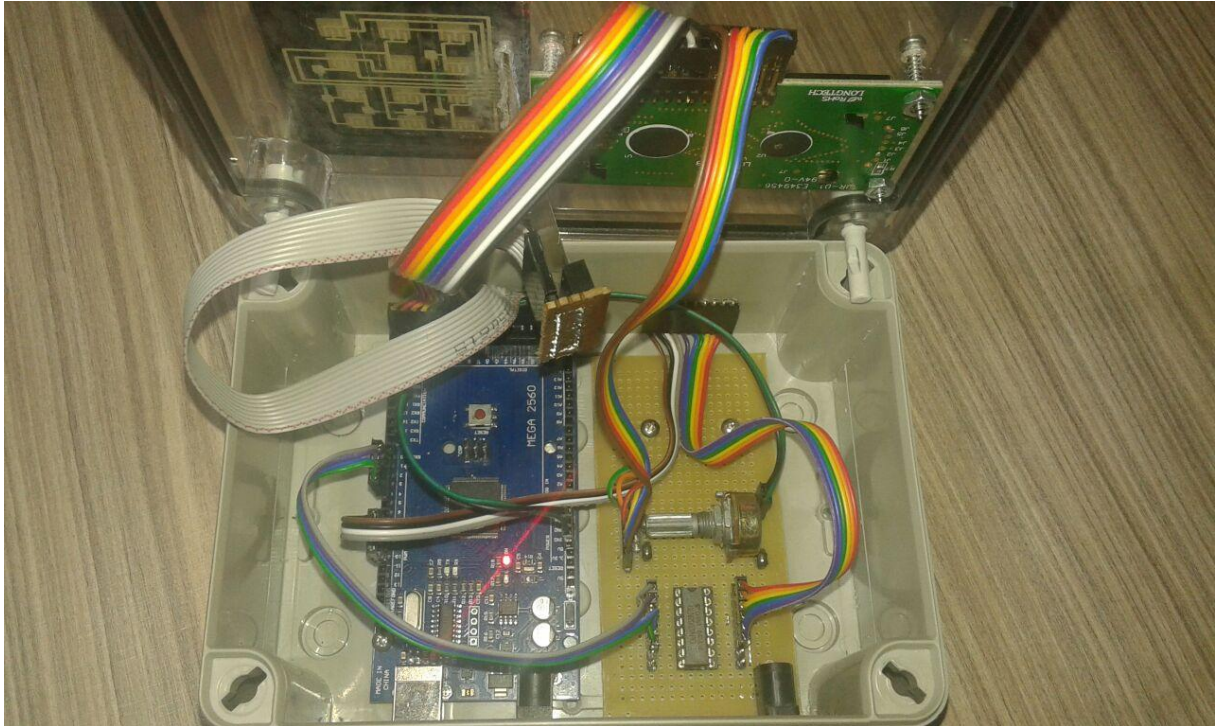
Figura 11 – Placa Microcontroladora e Placa de Potência Fonte: Autoria própria
