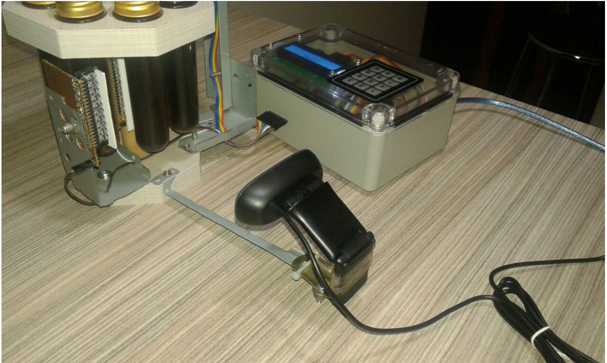
Figura 12 – Webcam Logitech HD C270 acoplada ao sistema Fonte: Autoria própria
