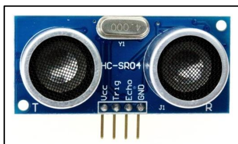
Figura 23 - Sensor ultrassônico HC-SR04 Fonte: FilipeFlop (2016a).
