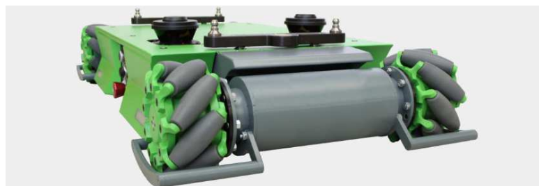
Figura 4 - Exemplo de utilização de mecanum (Fonte: www.donkey-motion.de )
