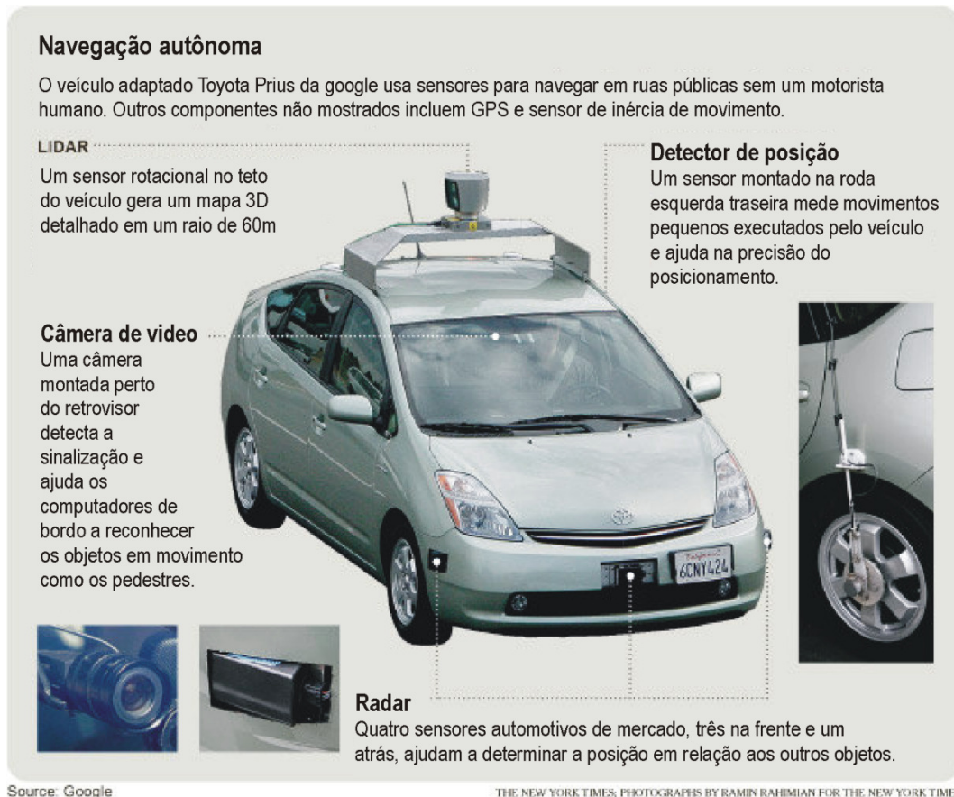
Figura 1 Foto do veículo autônomo ( driverless car ) da empresa Google mostrando também seus dispositivos que sentem o ambiente ao ser redor. Fonte: Traduzido de (MARKOFF, 2010).
