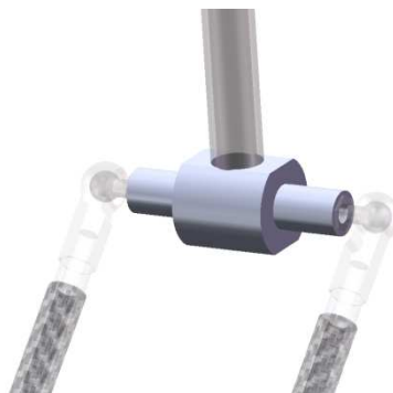
Figura 10 – Componente mecânico para ligação entre a haste superior e inferior. Fonte: Autoria própria.
