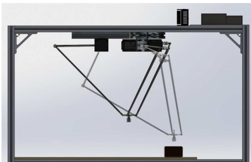
Figura 13 – Robô realiza a aproximação do objeto em alta velocidade. Fonte: Autoria própria.
