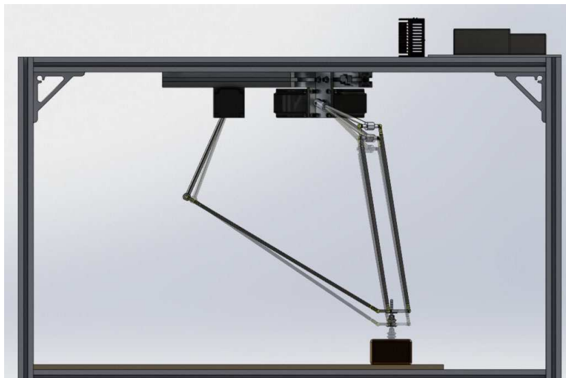
Figura 14 – Robô se aproxima do objeto com velocidade reduzida e atua o efetuator.
