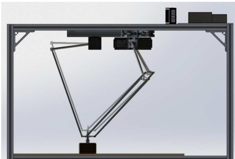
Figura 18 – Robô se afasta do objeto com velocidade reduzida e aguarda novo ciclo.
