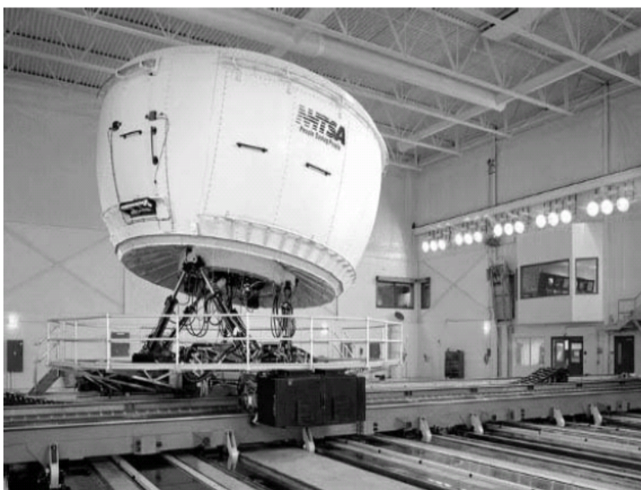
Figura 4 - Simulador de condução NADS da Universidade de Iowa. Fonte: Merlet (2006, p. 31).
