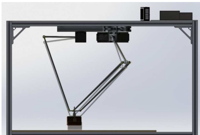
Figura 17 – Robô se aproxima da mesa para posicionar o objeto. Fonte: Autoria própria.
