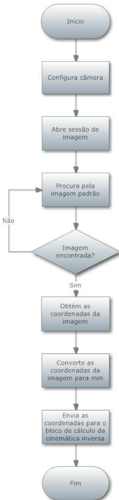
Figura 34 - Fluxograma das funções da câmera Fonte: Autoria própria.
