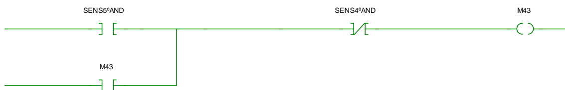
Figura 122 – Bloco de Intertravamento da Implementação do projeto Fonte: Autoria própria
