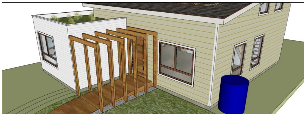
Figura 4 - Projeto Arquitetônico do Escritório Verde da UTFPR - Pergolado em pinus autoclavado Fonte: (CASAGRANDE JUNIOR, 2011).
