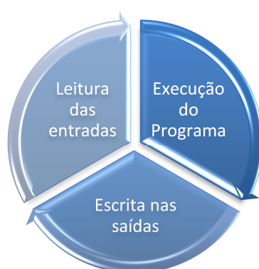
Figura 20 - Ciclo de Processamento de um CLP Fonte: Autoria Própria.
