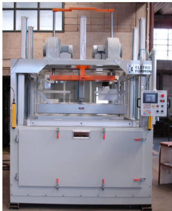
Figura 1 - Vista Frontal de uma Termoformadora Fonte: Eletro-Forming (2011).
