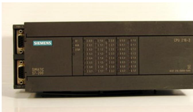
Figura 44 - CLP Siemens S7-200 CPU 216-2 Fonte: Aatoria Própria.
