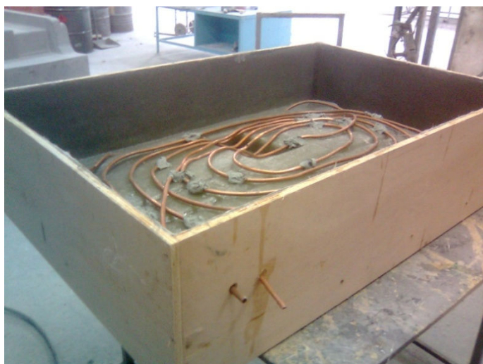
Figura 13 - Serpentina no Molde em Fase de Construção Fonte: MLM Indústria e Com. de Artefatos Plásticos (2010).
