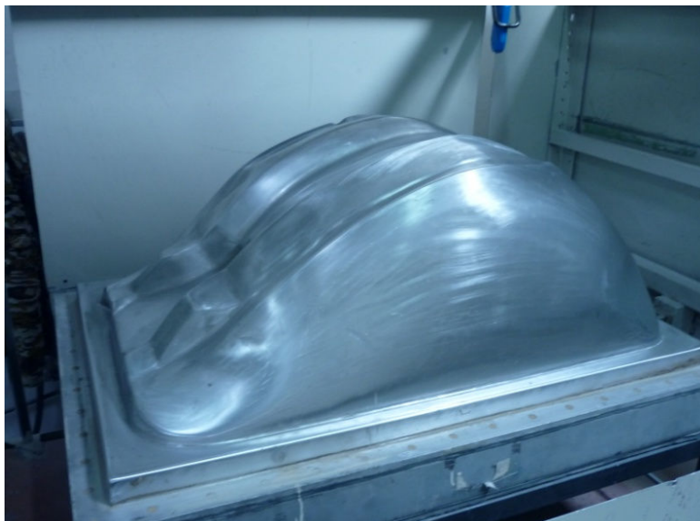
Figura 14 - Exemplo de um Molde de Alumínio Fonte: MLM Indústria e Com. de Artefatos Plásticos (2010).
