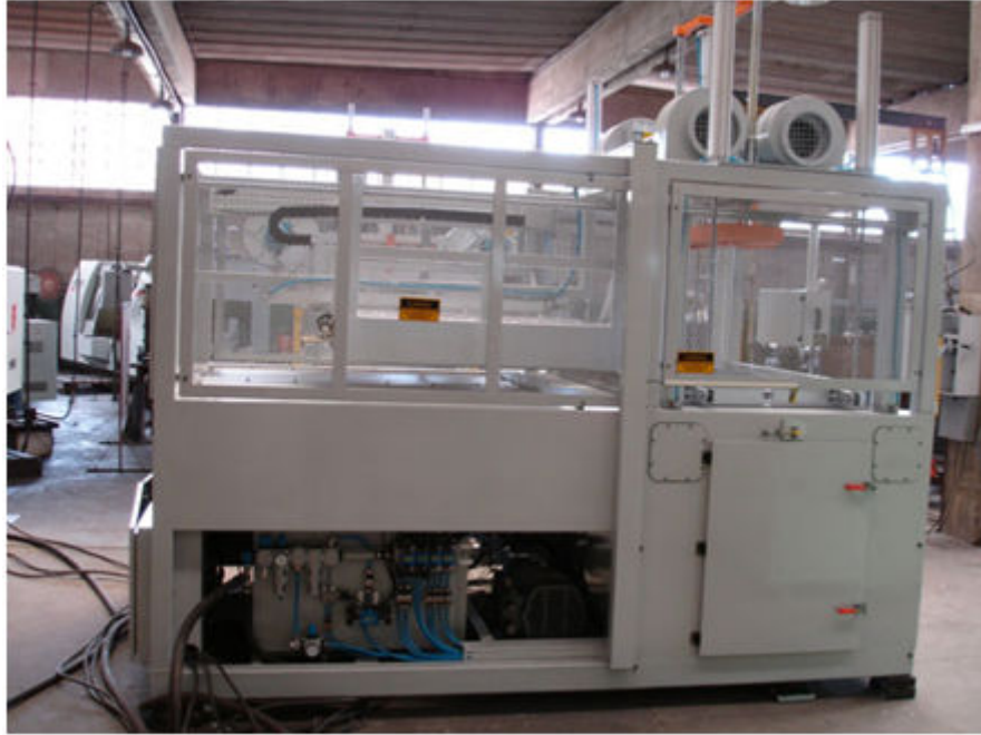
Figura 2 - Vista Lateral de uma Termoformadora Fonte: Eletro-Forming (2011).
