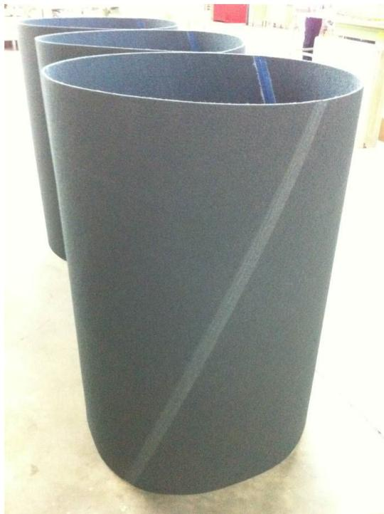
**Figura 6 - Imagem de rolos de lixa, utilizada em máquinas de acabamento**
