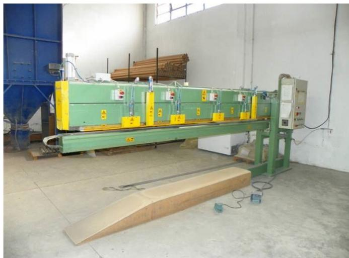
**Figura 1 - Foto da prensa para fechamento de rolos de lixa**
