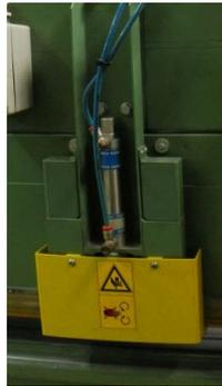
**Figura 28 - Sapatas de fixação do sistema**
