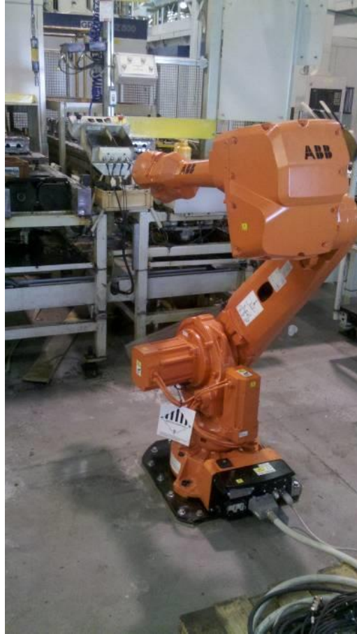
Figura 22- Robô chumbado na estação de trabalho. Fonte: Autoria própria.
