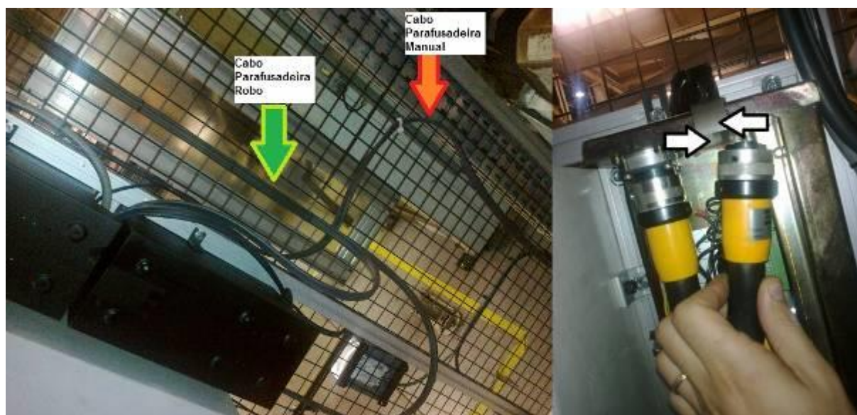
Figura 40- Troca de cabos da parafusadeira. Fonte: Autoria própria.
