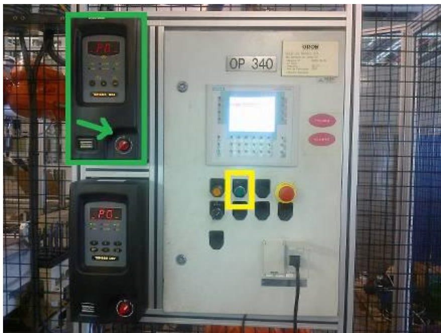
Figura 38- Seleção de função e desligamento da parafusadeira. Fonte: Autoria própria.
