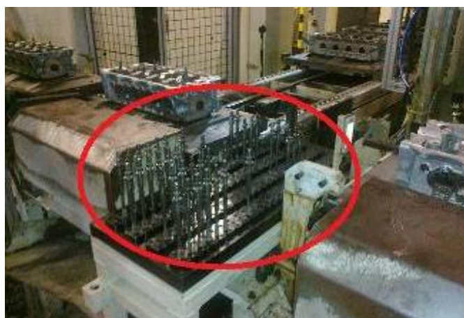
Figura 41- Retirada de parafusos do pulmão. Fonte: Autoria própria.
