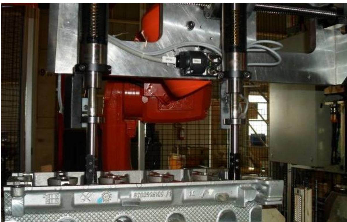
Figura 29- Sensores inferiores da garra acionados. Fonte: Autoria própria.
