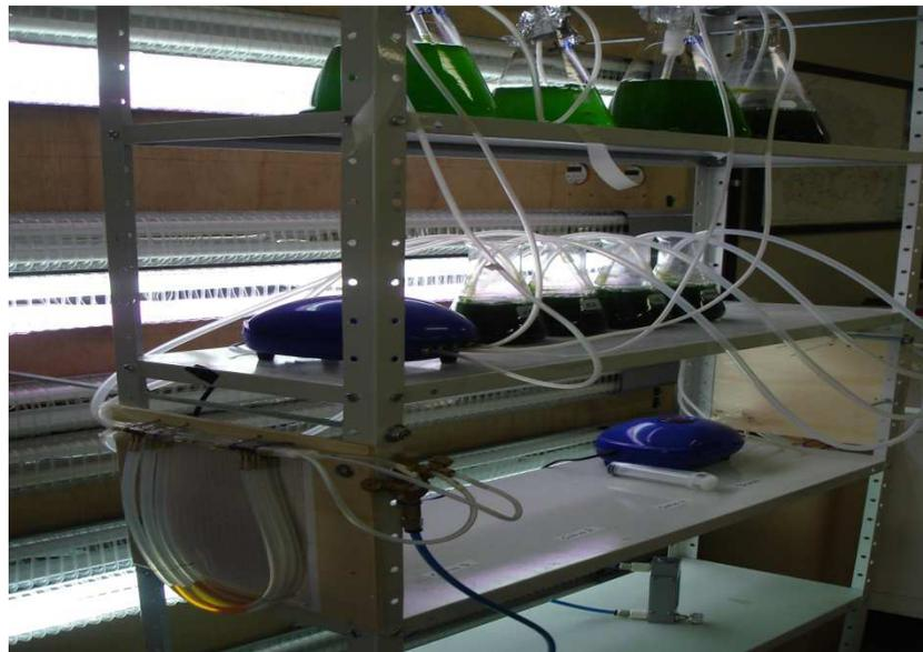
**Figura 10 - Controlador de vazão em funcionamento**
