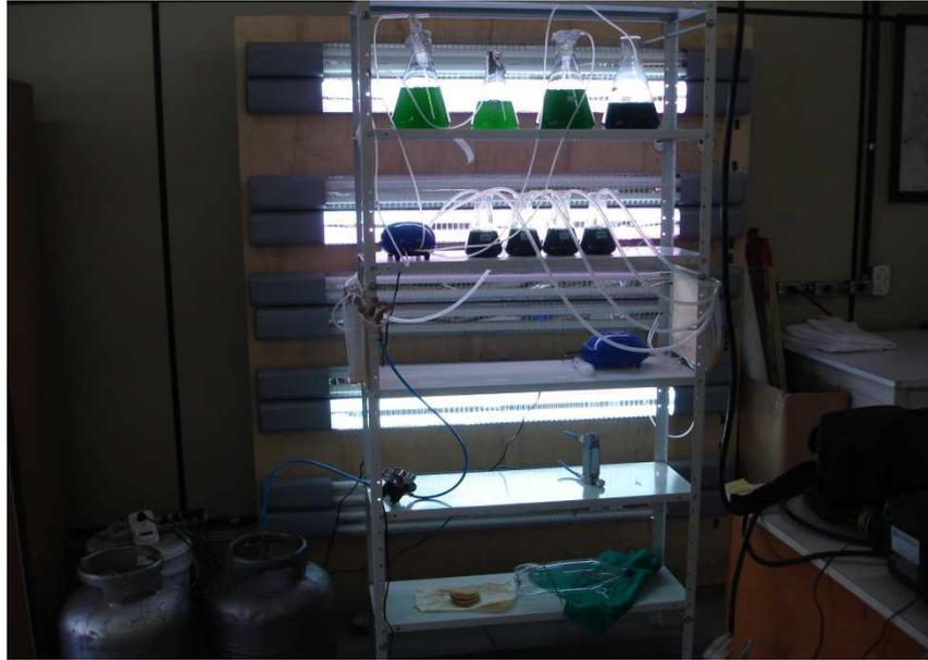
**Figura 9 – Bioreator em escala laboratorial**
