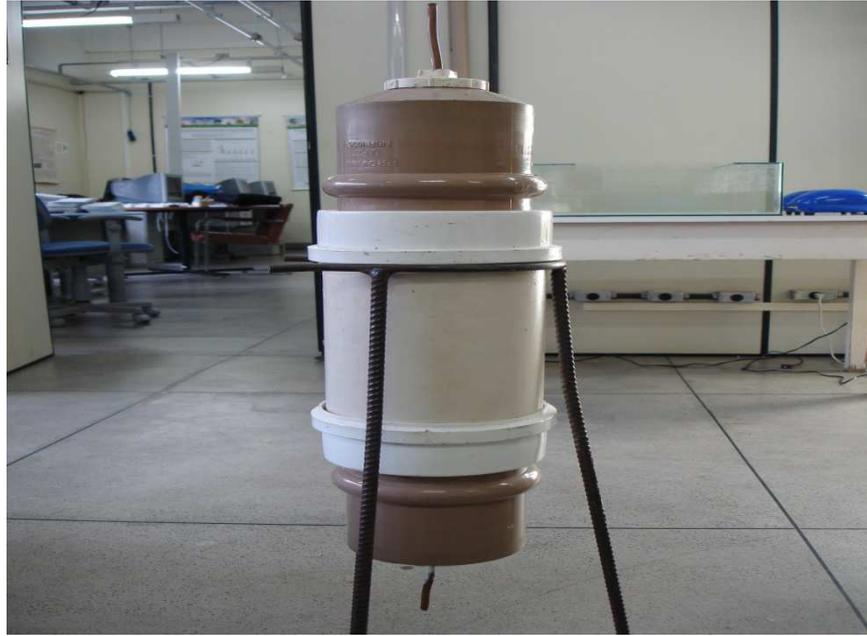
**Figura 8 – Condensador produzido em laboratório**
