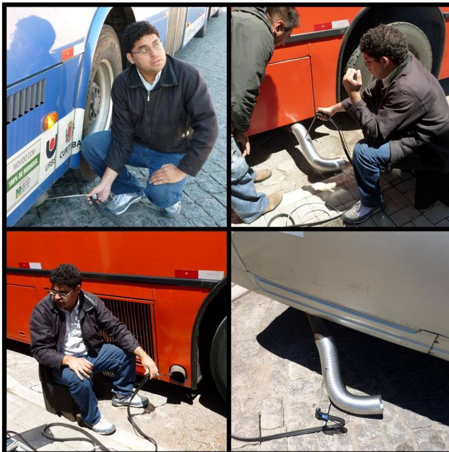
Figura 15. Medição dos gases pela sonda do equipamento diretamente no escapamento dos veículos e utilizando o tubo APA.
