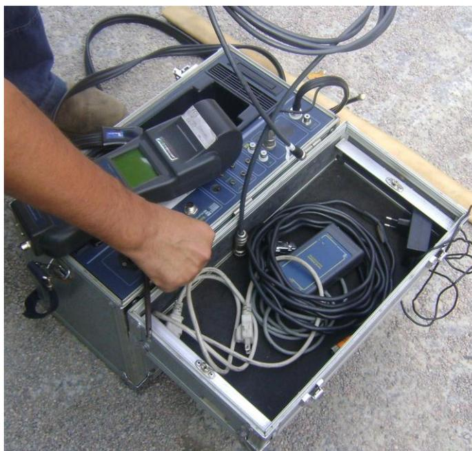
Figura 14. Foto do analisador de Gases de Combustão Ecil Ecoline 6000.
