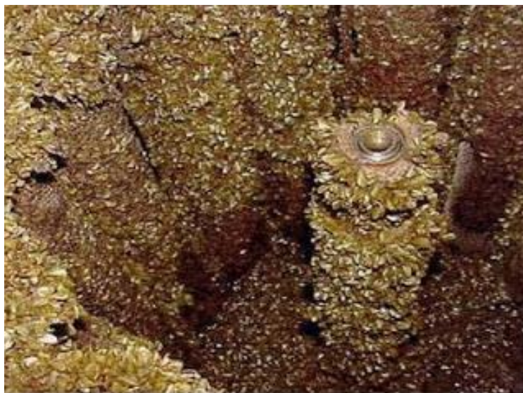
Figura 7. Turbina em Itaipu com incrustações de Mexilhão – Dourado Fonte: PASINI, 2011
