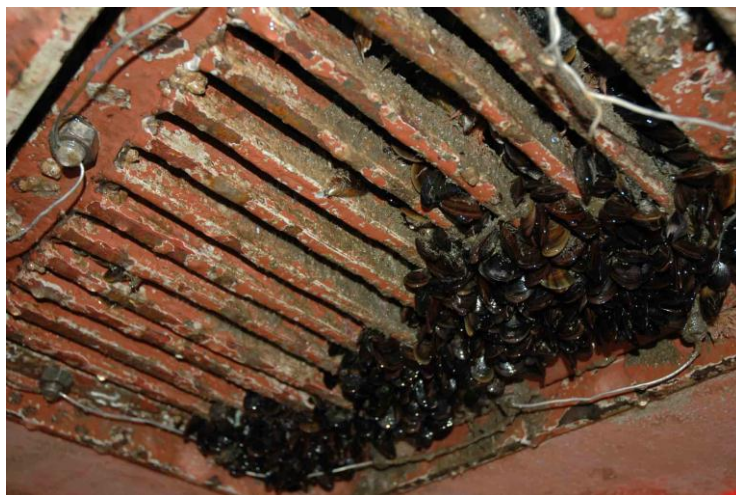
Figura 3. Incrustações em grelha de casco de navio comercial Fonte INSPECT
