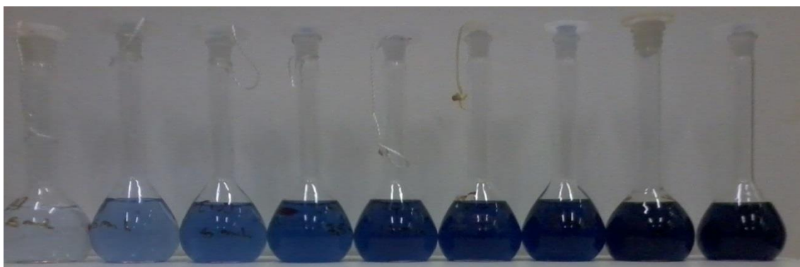
Figura 11: Soluções padrão de corante Preto Reativo 5, da esquerda para a direita: 1 \text{ mg.L}^{-1} , 5 \text{ mg.L}^{-1} , 10 \text{ mg.L}^{-1} , 15 \text{ mg.L}^{-1} , 20 \text{ mg.L}^{-1} , 25 \text{ mg.L}^{-1} , 30 \text{ mg.L}^{-1} , 40 \text{ mg.L}^{-1} , e 50 \text{ mg.L}^{-1} .
