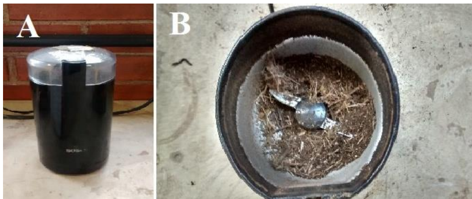
Fotografia 7: A - Triturador doméstico da marca Boch, modelo MKM 6003, utilizado para moer as amostras do composto orgânico resultante de vermicompostagem. B - Vista de cima do triturador.
