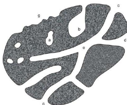
Figura 3. Grão de carvão ativado contendo diferentes tipos de poros: a. poro fechado; b, c, d, e. poros abertos; b. formato garrafa; c. formato cilíndrico; d. formato funil.
