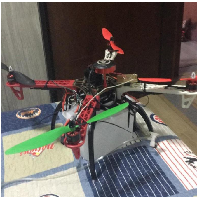
Figura 1 – Quadcopter F450 Fonte: Autoria própria
