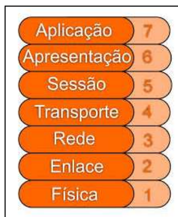
Figura 4 - Estrutura de recebimento de mensagem segundo o modelo OSI. Fonte: Adaptado de IMASTERS (2013).
