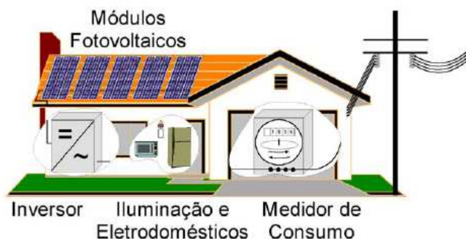
Figura 8 – Esquema de um Sistema FV Conectado à Rede Elétrica. Fonte: SEVERO, 2005.
