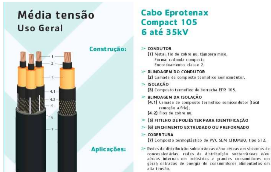
Figura 7- Trecho do catálogo do cabo Eprotenax Compact 105 da PRYSMIAN CABLES AND SYSTEMS SA, que emprega EPR na isolação
