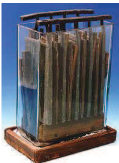
Figura 25: Bateria de Gaston Planté Fonte: ROBERGE, 2013
