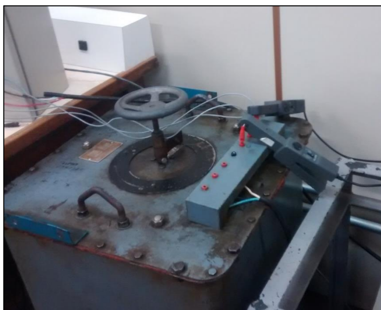
Figura 24 – Variador de tensão trifásico Fonte: Autoria Própria.
