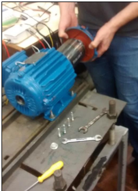
Figura 43 – Operação de troca do rotor Fonte: Autoria Própria.
