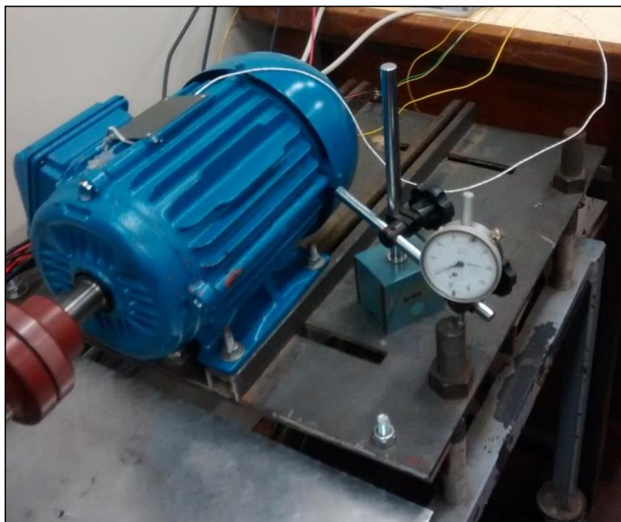
Figura 46 – Alteração do nível da base do motor Fonte: Autoria Própria.
