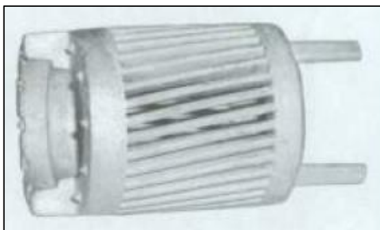
Figura 4 – Rotor do motor de indução do tipo gaiola de esquilo Fonte: Fitzgerald (2006, p. 297).
