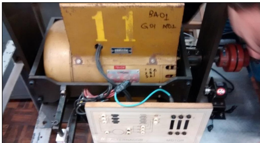
Figura 22 – Gerador síncrono usado como carga para o motor Fonte: Autoria Própria.
