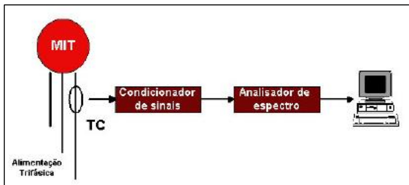
Figura 12 – Sistema básico para análise espectral da corrente Fonte: Bonaldi (2005).
