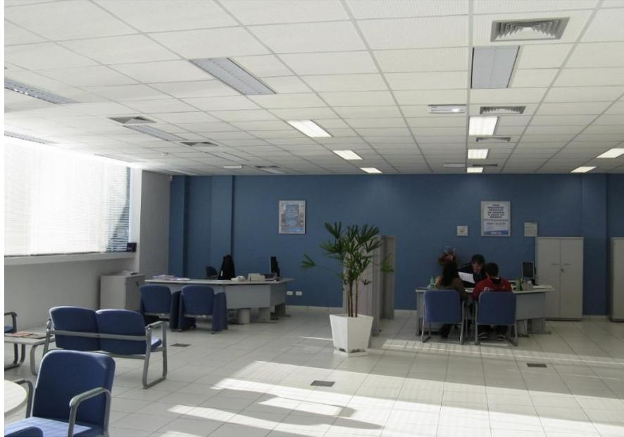
**Figura 37 - Iluminação perimetral para aproveitamento da luz natural**
