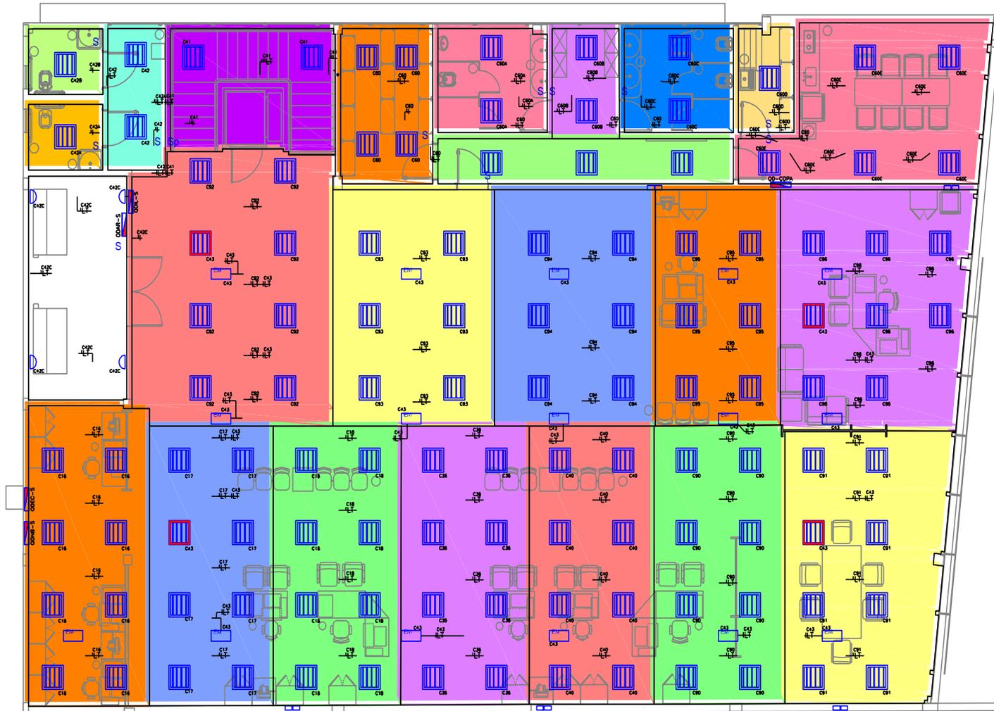
Divisão do circuito de iluminação da agência A – pavimento superior
