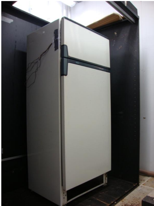
Figura 34 – Refrigerador Inserido na Câmara Climática (conforme ISO 8187)
