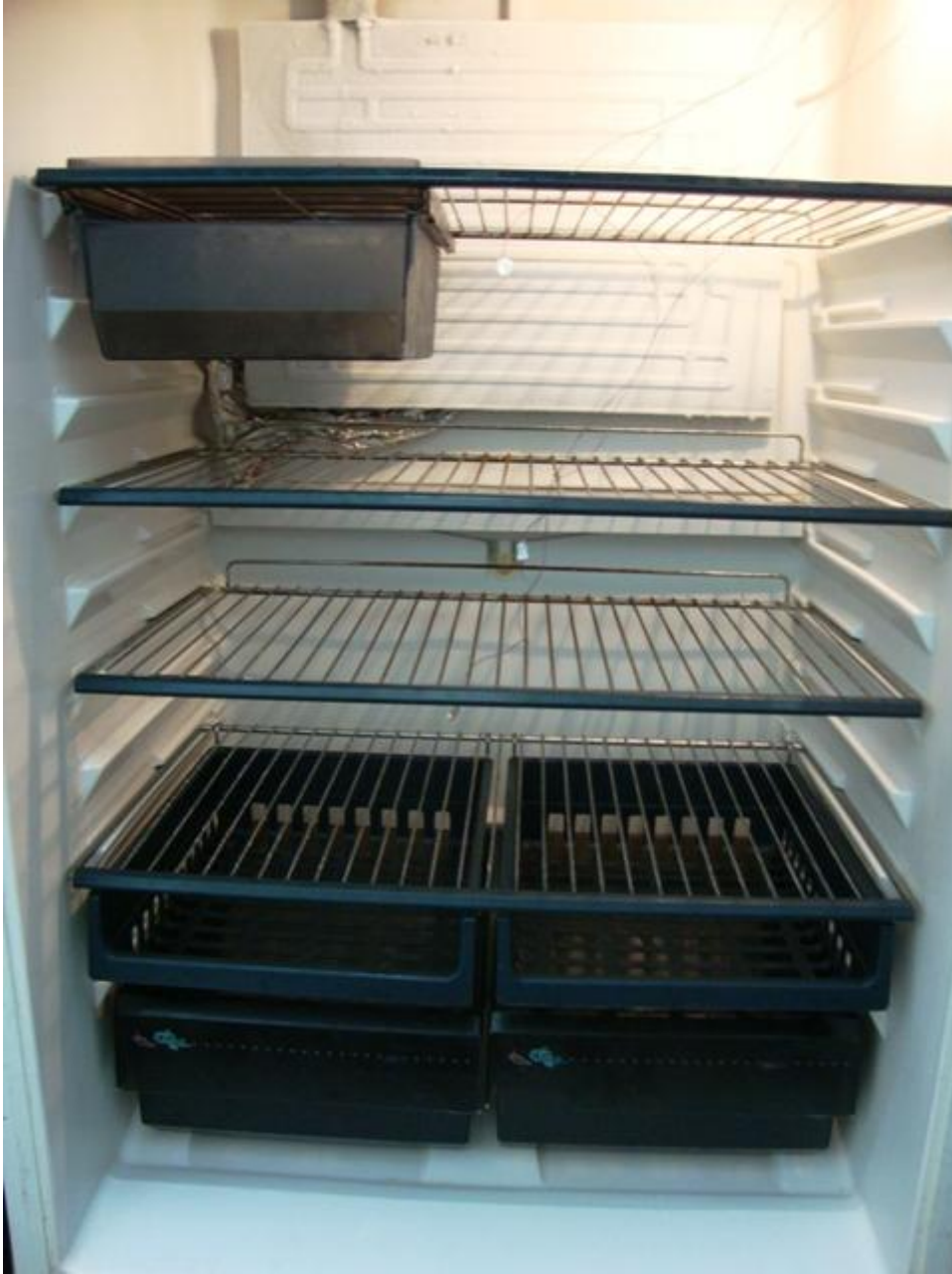
Figura 38 – Três Termopares Localizados a 1/3, 2/3 do Limite Superior e 25 mm do Limite Inferior do compartimento refrigerador.
