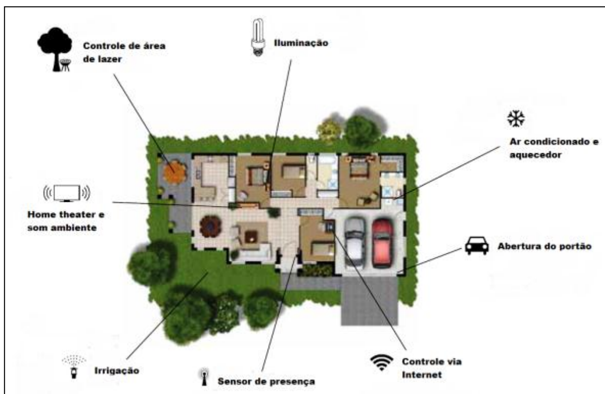
Figura 16: Outras possibilidades de controle de uma estrutura pré-automatizada Fonte: Adaptado de LUIZARI (2011)
