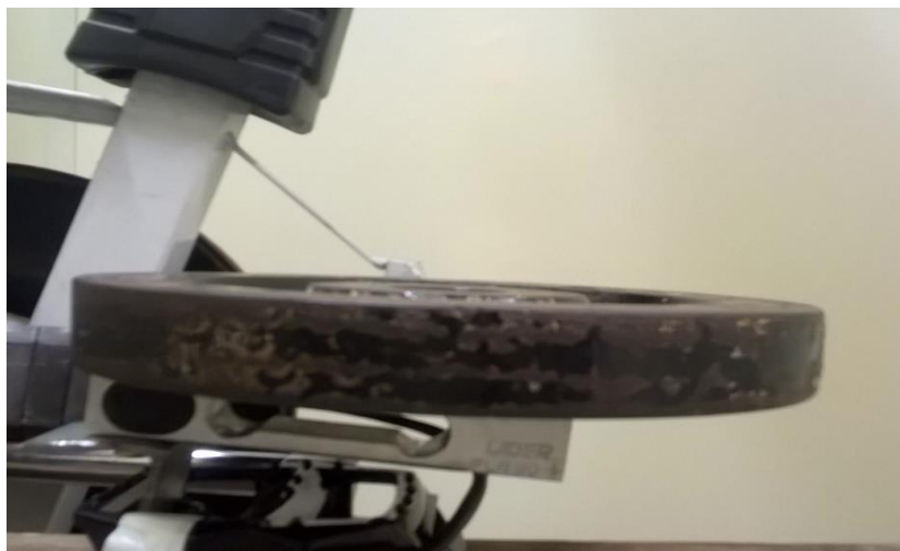
Figura 39 - Calibração com anilhas de 5 kgf cada. Fonte: Própria.
