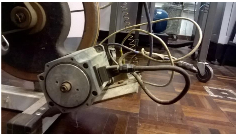
Figura 29 - Máquina elétrica utilizada como gerador. Fonte: Própria.
