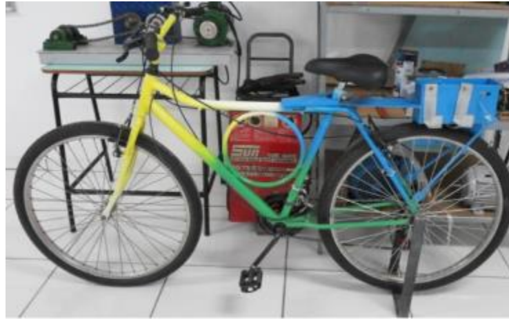
Figura 1 - Bicicleta adaptada com alternador. Fonte: Ramos e Setúbal, (2013).
