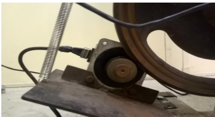
Figura 30 - Detalhe de fixação do gerador e conexão com polia Fonte: Própria.
