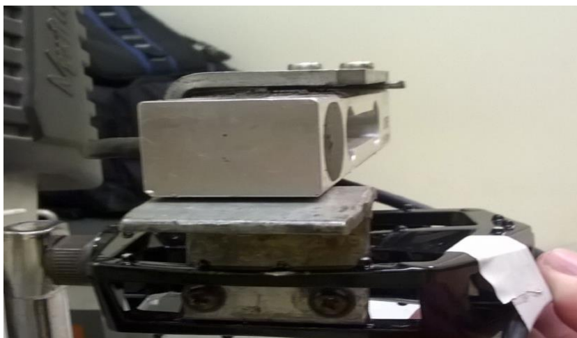
Figura 25 - Fixação da célula de carga no pedal Fonte: Própria.
