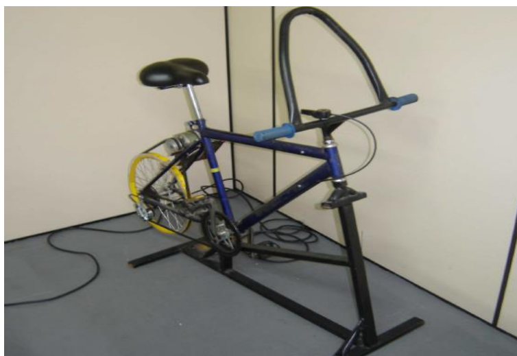
Figura 4 – Bicicleta adaptada ao gerador Fonte: Batista e Brambilla (2010).
