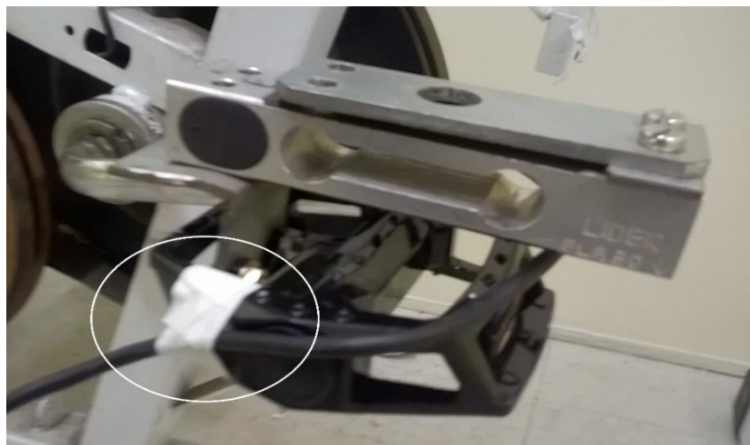
Figura 26 - Fixação dos cabos de saída das células de carga. Fonte: Própria.
