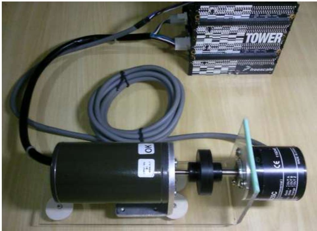
Figura 15 – Sistema de acionamento e leitura de velocidade do motor Fonte: Autoria Própria
